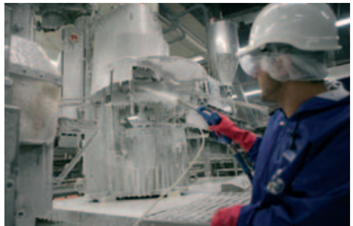
Abb. 5: Moderne Betriebsreinigung basiert auf einer Vielzahl effektiver Reinigungsprozesse – hier das Einschäumen mit hocheffektivem Reinigungsschaum.
