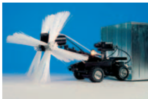
Abb. 2: Der halbautomatische Reinigungsroboter mit Bürstenaufsatz befreit unzugängliche Lüftungskanäle von innen von Verschmutzungen.
